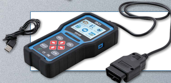
OBD II (EOBD) Fehlerdiagnosegerät
